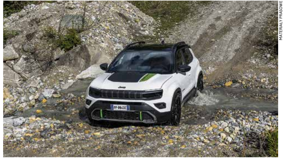
Prześwit został zwiększony o 10 mm, a zdolność brodzenia została zwiększona do 400 mm
